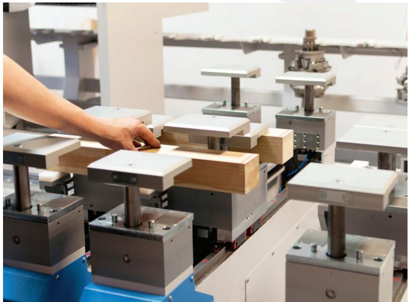
Středový upínač má nastavitelnou narážku podle okenního profilu. První dvě konzoly jsou určeny také pro velmi krátké dílce a dovolují ruční výrobu speciálních dílců.
