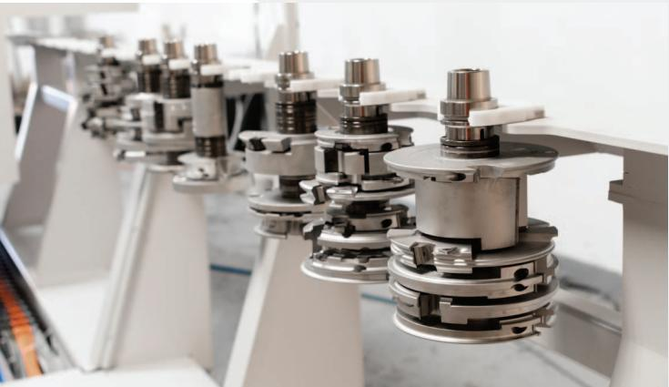
Lineární zásobník s 21 pozicemi může nést až 42 profilů, což je pro hlavní práci dostačné. Tool manager dává pevnou pozici často používaným nástrojům a příležitostně používané nástroje jsou ukládány do zásobníku, když se budou používat.
