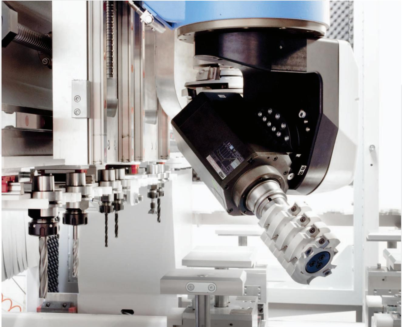
Flexibilní 5osé elektrovřeteno 7kW s harmonickou převodovkou a torzními v ose A a C je opět chlazené kapalinou. Vrtací a dlabací nástroje jsou osazeny na upínačích s HSK63F. Jednotka také pracuje s nástroji pro změnu profilu pro otvíravé a pevné zasklení, 3D operace a pilu do průměru 400 mm.
